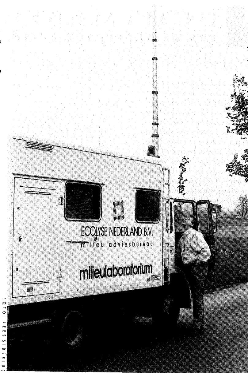
Henk Grit van Ecolyse schuift de snuffelmast omhoog. De mast van de luchtmeetwagen kan tot 10 meter hoog reiken
